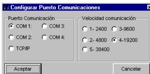
comunicaciones. Si la conexión se realiza a través de Ethernet con protocolos TCP/IP, podrá modificar la dirección IP haciendo clic sobre el selector TCP/IP. En este caso la velocidad de comunicaciones no se puede alterar y queda fijada a 19200. **EVCPwin** guarda en el archivo **comsel.cfg** la configuración del puerto de comunicación.
